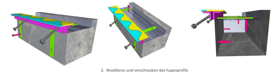
Das Fugenprofil auf die gewünschte Achsenlänge mittels eines Trennschneiders ablängen. Bei einer Achslänge größer als 2500 mm müssen die einzelnen Elemente mittels der integrierten Verbindungsschrauben verlängert werden. Der Fugenprofilkopf muss waagerecht und auf Höhe der Oberkante des Bestandbauteils einnivelliert werden. Unterstützen Sie hierzu die Montagelaschen am Profil mit Unterlegeplatten, um es auf gewünschte Höhe zu bringen.
