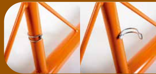
schnelle Demontage durch „easy klick“-Spannbolzen
